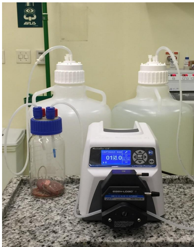
Figura 1. Biorreator e bomba de perfusão
