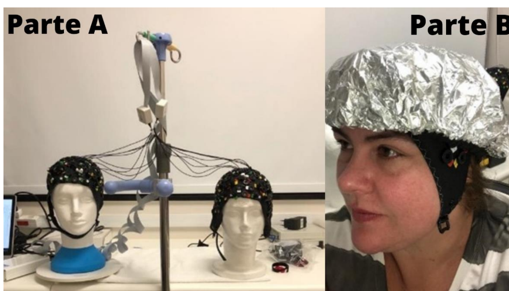
Parte A: as toucas previamente montadas e a estabilização da fiação fNIRS. Parte B: detalhe da touca de proteção.
